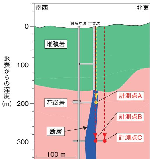
図 8-13 瑞浪超深地層研究所の地質分布とミュオンの計測点の関係
