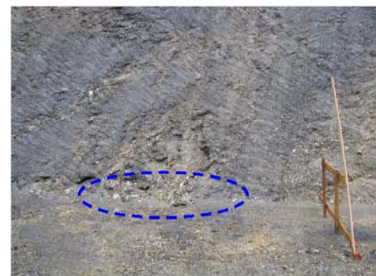
湧水状況 ① 岩盤の脆弱部分には湧水が確認できる
