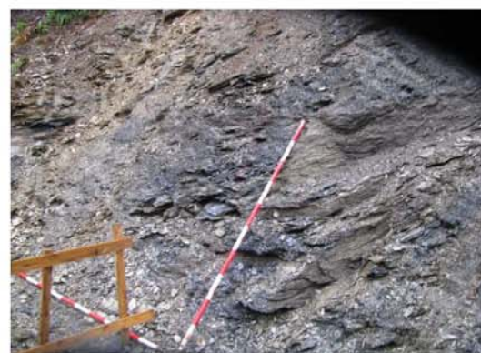
終点側岩盤状態は剥離性に富む
