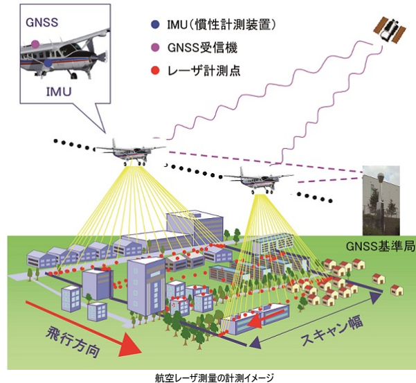
航空レーザ測量の計測イメージ
