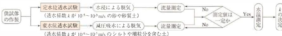
図-11.2 室内透水試験方法の概略
