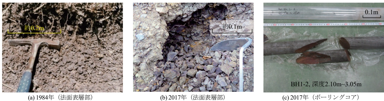
図 5 調査法面の表層部およびボーリングコア（地表から2.10～3.05 m）の状態
